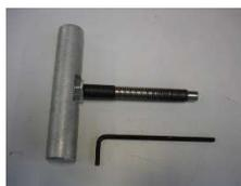
Le WIZ-KID est un ouvre fût léger (15 kg), certifié CE. Il est livré avec sa poignée en T et la clé de blocage de l'écrou de réglage de la hauteur de coupe.
