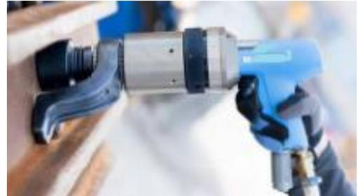
Pour l'application « vanne » il faut un couple suffisant sans précision particulière. Il n'y a pas besoin de l'affichage du couple, mais seulement un réglage progressif du couple (à vitesse constante).
