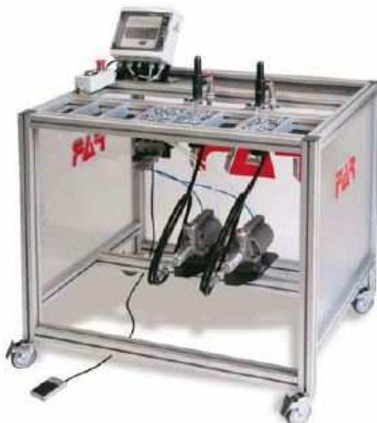
Le plan de pose des pièces est généralement réalisé au niveau de l'embouchure des têtes. L'entraxe minimum standard entre deux têtes est de 40 mm, avec récupération des queues de rivets dans un réservoir inférieur, ou 65 mm avec un bol de récupération.
