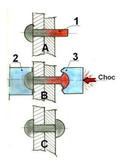
Les pièces métalliques sont percées (attention les alésages doivent être alignés). Le rivet est chauffé, puis introduit dans les alésages.
