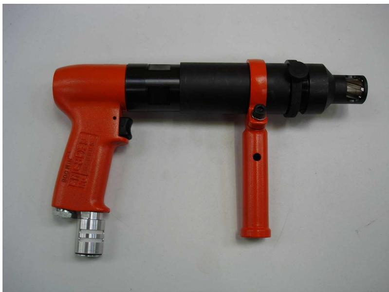
L'outil de démontage des rivets BOM est une fraiseuse pneumatique équipée d'une butée à réglage micrométrique (pouvant être utilisée comme avance micrométrique). La butée standard sert de centrage pour les rivets BOM 20.
