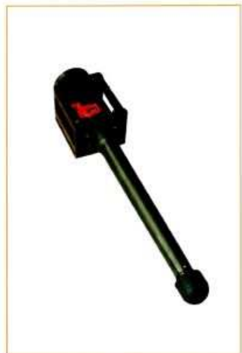
broche hydraulique longueur 1400 mm pour meule ogive
