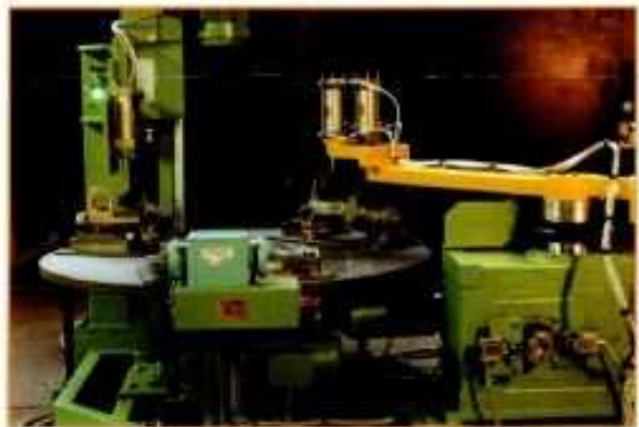
perçage sur plateau rotatif avec manipulateur
