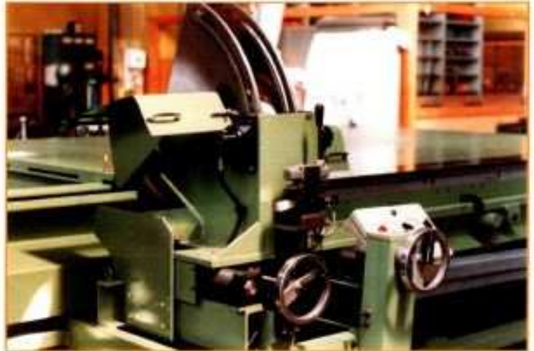
chanfreinage de tôle de blindage
