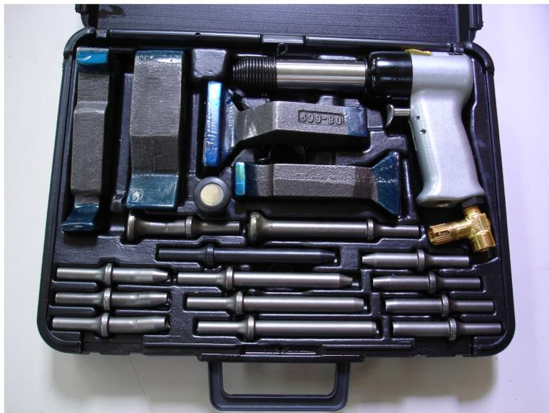
Les mallettes 53RGK comprennent l'équipement complet pour la pose de rivets pleins. Elles contiennent un burineur, des bouterolles et les tas adaptés.
