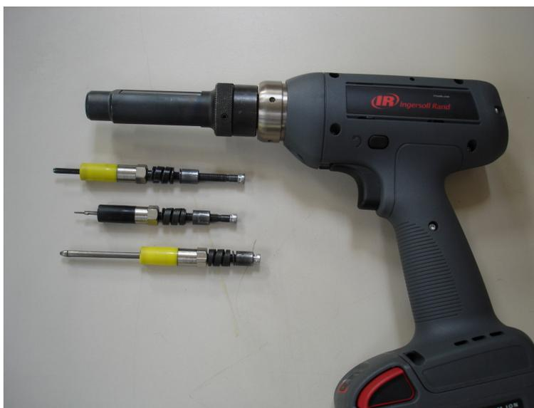
D'une manière générale il est possible d'utiliser des visseuses à batterie pour la pose des différentes agrafes.
