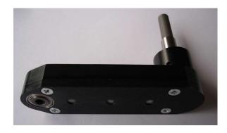
Les têtes déportées de perçage, ou caravelles, permettent des perçages dans des endroits réputés inaccessibles. Le déport est droit ou angulaire. La rotation est obtenue par un train d'engrenages. Les forêts sont vissés dans le dernier pignon (soit d'un côté, soit des deux côtés). Il existe de très nombreux modèles.
