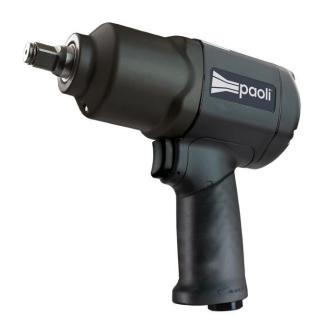
1100 N.m **Couple maxi** Couple recommandé 100 - 950 N.mMasse 2,1 kgLongueur 195 mm **Passage** 35 mm Vitesse à vide 8500 t/mn Nombre d'impacts 1050/mn **Vibrations**  $6.5 \text{ m/s}^2$ Niveau sonore 96 dB(A)
