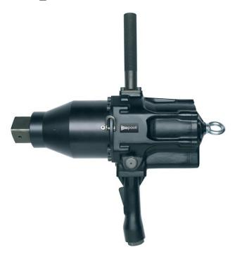
Couple maxi 26400 N.m 6050 - 8800 N.m Couple recommandé Masse 67 kg Longueur 640 mm **Passage** 96 mm Vitesse à vide 2100 t/mn Nombre d'impacts 400/mn  $13,7 \text{ m/s}^2$ **Vibrations** Niveau sonore 114 dB(A)
