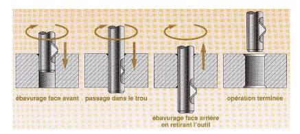
Vitesse de coupe : 15 à 30 m/mn pour les aciers, et jusqu'à 60 m/mn pour les non ferreux Avances : de 0.05 à 0.15 mm/tr
