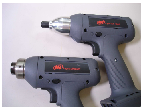
Visseuse QX standard et visseuse QX modifiée
