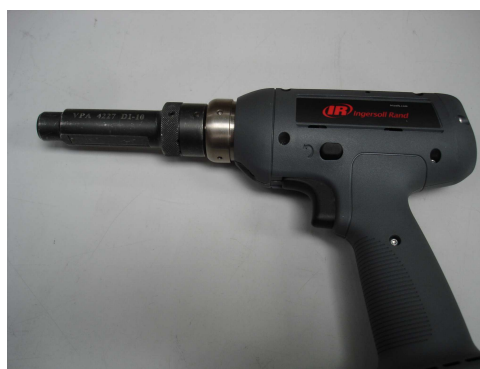
Visseuse QX modifiée équipée du nez de pose série 42
