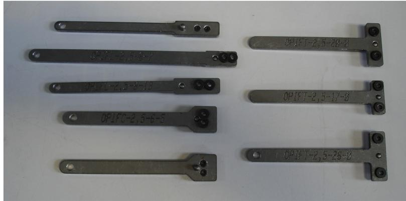
Les fourchettes sont des gabarits de perçage généralement utilisés pour la mise en place des écrous à rivet (anchor nuts).
