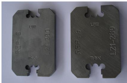
Il existe aussi des gabarits pour vérifier la bonne rupture des rivets (ci-dessous pour rivets VISU-LOK ou JO-BOLT)
