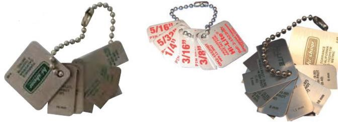
Pour vérifier la pose correcte des rivets il existe des gabarits de contrôle standard (vérification de la bonne pose de sertissage).
