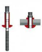
**Très large surface de contact côté aveugle:** idéal pour l'assemblage de matériaux de faibles épaisseurs, ou de faibles duretés
