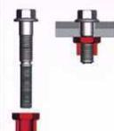
**Boulon sertis de gros diamètre de classe 10.9 (installé)**
