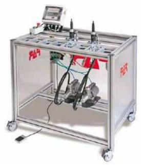
Le plan de pose des pièces est généralement réalisé au niveau de l'embouchure des têtes. L'entraxe minimum standard entre deux têtes est de 52 mm.
