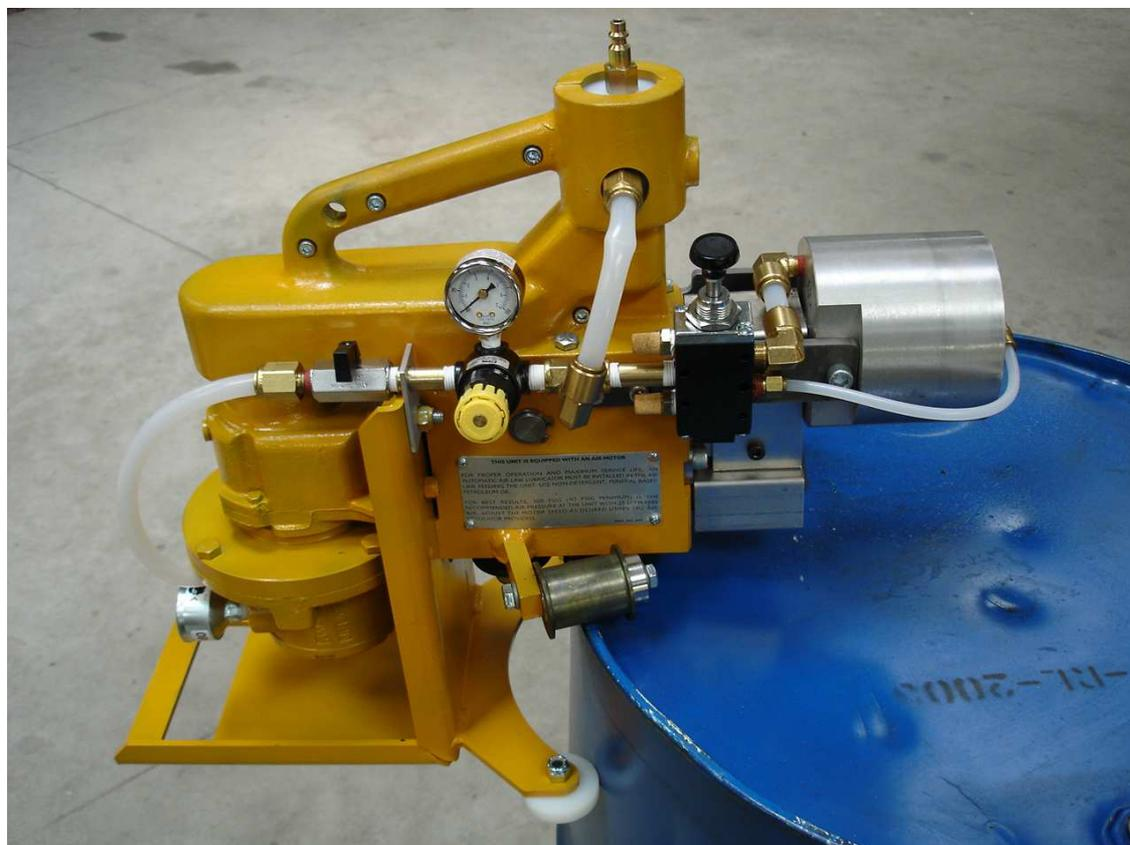
**L'ouvre fût pneumatique motorisé découpe le couvercle ou le fond des fûts standard en acier de 120 à 220 litres et d'épaisseur 0,8 à 2 mm.**
