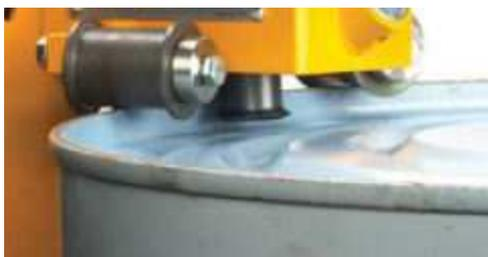
**Le réglage des galets s'effectue par les supports excentriques.**
