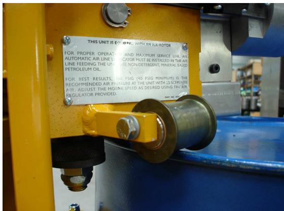
Le réglage de la position de la molette s'effectue par le réglage de la position des galets supports qui sont montés sur excentriques.
