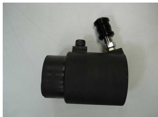
Ce tas pneumatique a été conçu pour les opérations de rivetage à chaud avec accès réduit.
