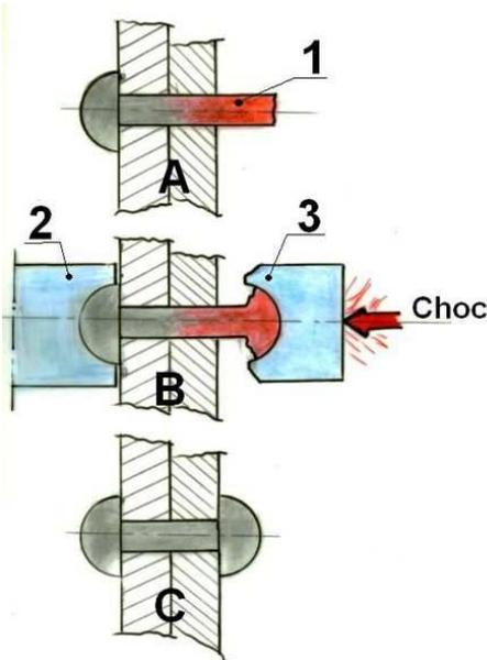
Les pièces métalliques sont percées (attention les alésages doivent être alignés).
