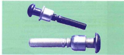
Le type de rivets le plus couramment utilisé pour ponts, charpentes métalliques, ponts roulants, ... est la famille **C50** qui existe en diamètre jusqu'à 34,9 mm (dimensions américaines) pour sertir des épaisseurs jusqu'à 160 mm, en qualité équivalente à la Classe 8.8, avec possibilité de garantir l'étanchéité sous pression.
