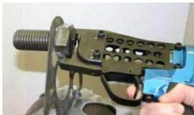
L'outil de sertissage SFEE 1-1125 permet la mise en place des freins d'écrou. Cet outil est principalement utilisé dans l'industrie ferroviaire pour assurer l'indesserrabilité des vis d'axes d'essieu.
