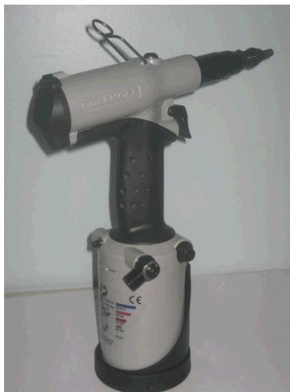
Cet appareil permet la pose des écrous noyés RIVKLE® par réglage de la pression.
