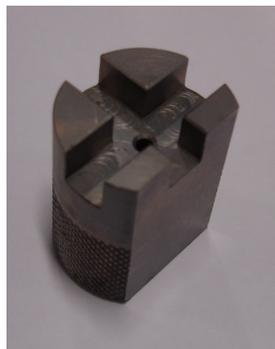
Un pied de perçage est un accessoire qui permet de guider un forêt perpendiculairement à la surface d'appui. Un moletage garantit une bonne prise en main.
