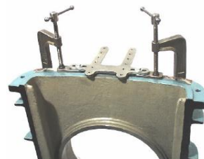
Serrage avec étai (en haut) et serre-joints (en bas)
