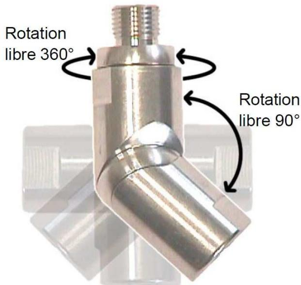
Les raccords orientables à passage intégral sont libres dans toutes les directions. Ils existent dans toutes les dimensions standard, de 1/4'' à 1'' pour l'air comprimé, et au dessus pour d'autres fluides.
