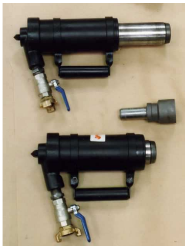
Tas standard (dans les deux positions extrêmes) avec une contre bouterolle.
