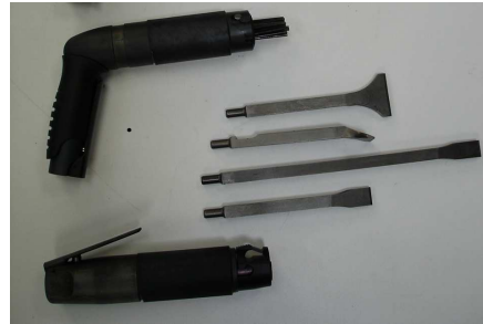
Détartreur GNV 19 et burineur HRV 600 anti vibratiles, et jeu de burins.
