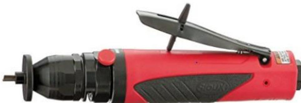
Cette détoureuse est prévue pour être utilisée avec un guide dont le diamètre est défini en fonction du gabarit (par exemple, pour une fraise de Ø 6 et un déport de 1,6 mm, le diamètre du guide doit faire 9,2 mm).
