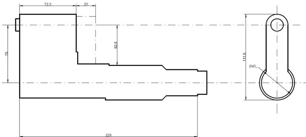
Les têtes déportées sont prévues pour poser des rivets lorsque l'accès est difficile.
