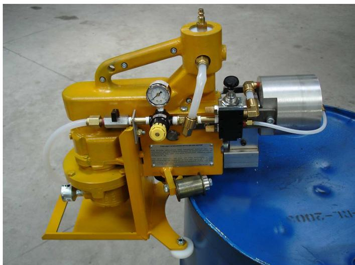
**L'ouvre-fût pneumatique motorisé permet l'ouverture très rapide des fûts standard en acier de 120 à 200 litres par découpe du couvercle.**
