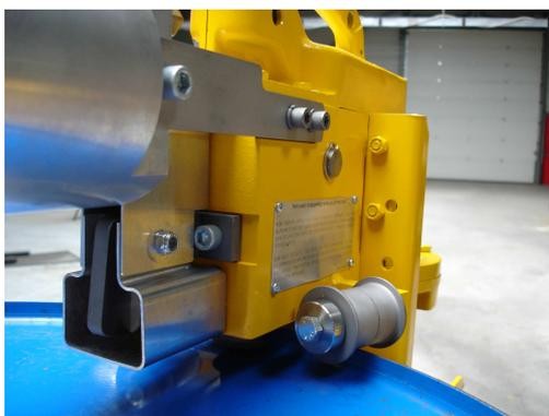
**Les galets sont montés sur excentriques, ce qui permet de régler la position de la coupe.**
