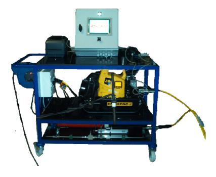
Ce nouveau système de pilotage des clés hydrauliques permet leur utilisation en production de série. Les principaux avantages sont :
